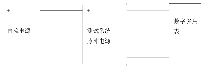
图 6 测试系统脉冲电源电压表示值校准连接图
